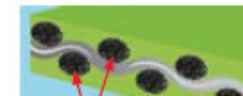
Imprégnation totale des fils dans la matière. Total coating impregnation of the yarn.
